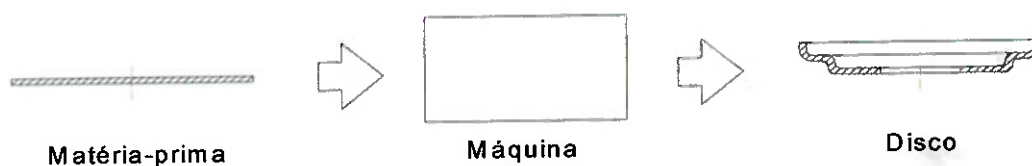
Figura 23 - Processo esquemático de fabricação do disco
