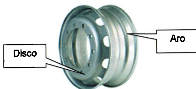
Figura 22 - Roda em aço de caminhão e seus componentes
