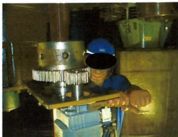
Figura 72 - Mecânico fazendo a fixação do conjunto da motorização das porcas da almofada
