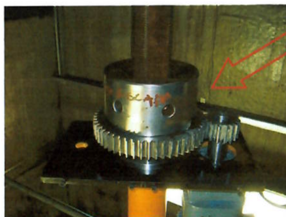
Figura 73 - Detalhe do conjunto de motorização das porcas da almofada em fase de montagem
